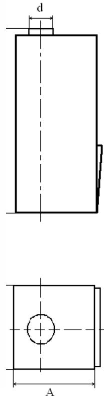
Модуль агрегата, предназначенный для подключения воздухопроводов, может выполняться с патрубками диаметра 80 мм или 100 мм.
