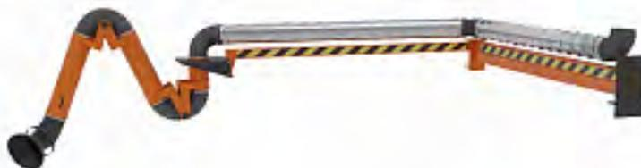
Радиус обслуживания 8м, диаметром 160мм
